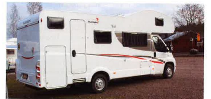
Ulko-oven yläpuolella ei ole lippaa, joten sateella ovea avattaessa vesi kastelee heti oven sisäpinnan ja siinä mahdollisesti roikkuvat takit. Rainkasvesisäiliön täyttöaukko kaipaa luukkua korkin lisäksi.
